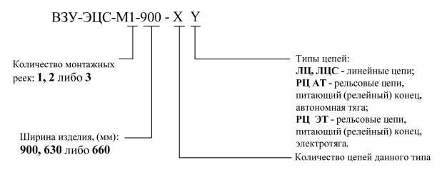
Для обозначения каналов защиты линейных цепей используется индекс ЛЦ. Для обозначения каналов защиты приборов диагностики (для которых предусмотрена функция отключения прибора при выходе из строя устройства защиты) используется индекс ЛЦС.
