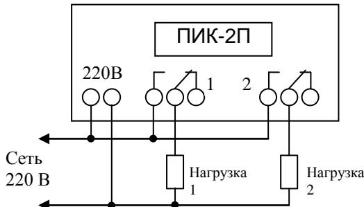
Подайте питание на реле. Для предварительной зарядки аккумулятора оставьте реле включенным в сеть на время не менее 8 час.
