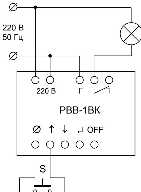
При нажатии на кнопку “S” запускается обратный отсчет времени, замыкаются нормально разомкнутые контакты реле, и включается лампочка. По истечении 5-ти минут контакты размыкаются и отключают лампочку.
