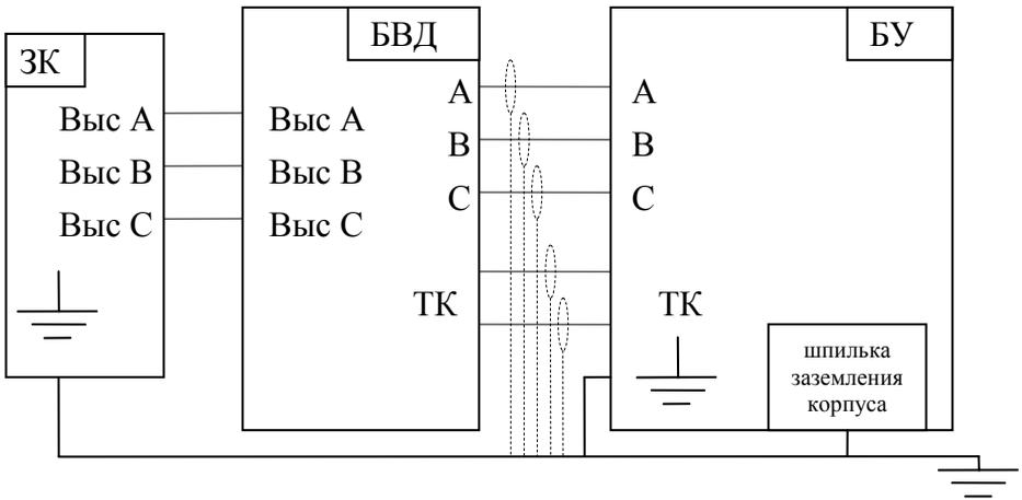
Рисунок 4 – Соединение блоков ППКСИ для калибровки
