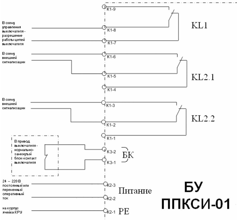
Рисунок 2 – Схема подключения сигнальных цепей и питания ППКСИ
