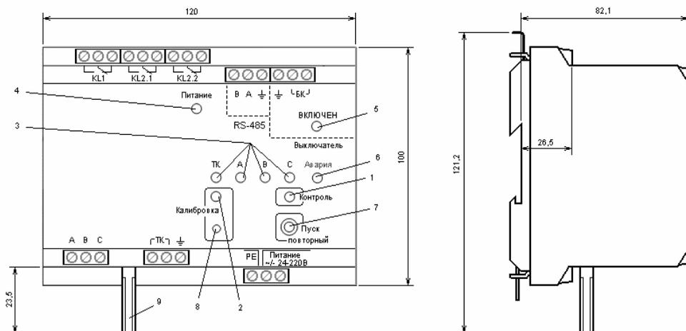
1 – синий светодиод «Контроль». Горит, когда проводится измерение сопротивления изоляции
