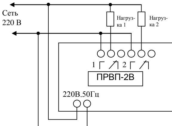
Подайте питание на реле. Для предварительной зарядки аккумулятора оставьте реле включенным в сеть на время не менее 8 часов.
