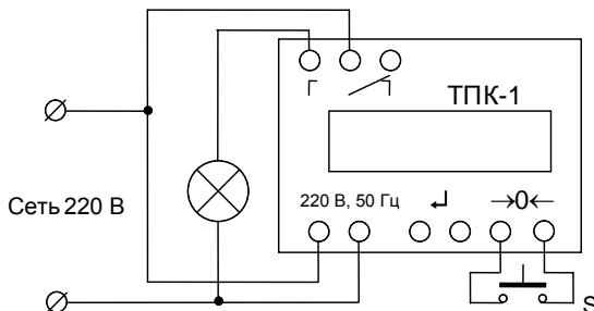
При нажатии на кнопку “S” обнуляется время, замыкаются согласно введенной программе нормально разомкнутые контакты реле, которые включают лампочку. По истечении 5-ти минут контакты размыкаются и отключают лампочку.
