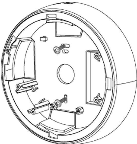
Подключите громкоговоритель к подведеному кабелю трансляционной линии, а затем соедините обе части устройства, совместив установочные метки на корпусе и повернув лицевую часть по часовой стрелке до щелчка фиксатора.
