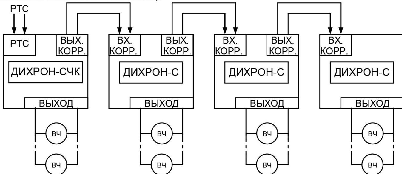
Суммарное сопротивление 2-х проводов между контактами «ВЫХ.КОРР.» предыдущих первичных часов и контактами «ВХ.КОРР.» последующих должно быть не более 150 Ом (800 м провода сечением 0,2 мм<sup>2</sup>).
