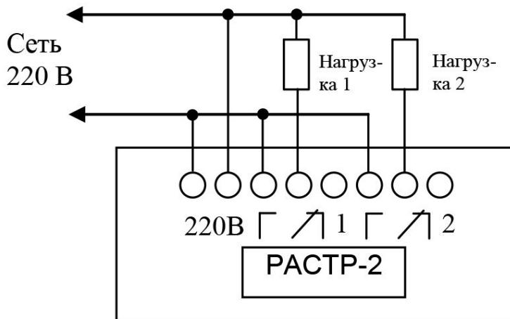
Подайте питание на реле. Для предварительной зарядки аккумулятора оставьте реле включенным в сеть на время не менее 8 часов.
