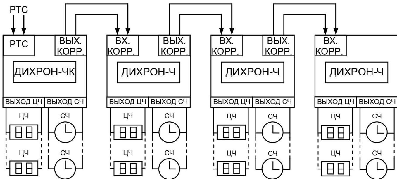
Суммарное сопротивление 2-х проводов между контактами “ВЫХ. КОРР.” предыдущих первичных часов и контактами “ВХ. КОРР.” последующих должно быть не более 150 Ом (800 м провода сечением 0,2 мм<sup>2</sup>).
