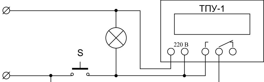
При нажатии на кнопку “S” включаются реле, лампочка и замыкаются нормально разомкнутые контакты реле, которые фиксируют цепь питания реле и лампочки после отпускания кнопки. По истечении 5-ти минут контакты размыкаются и отключают лампочку и реле.
