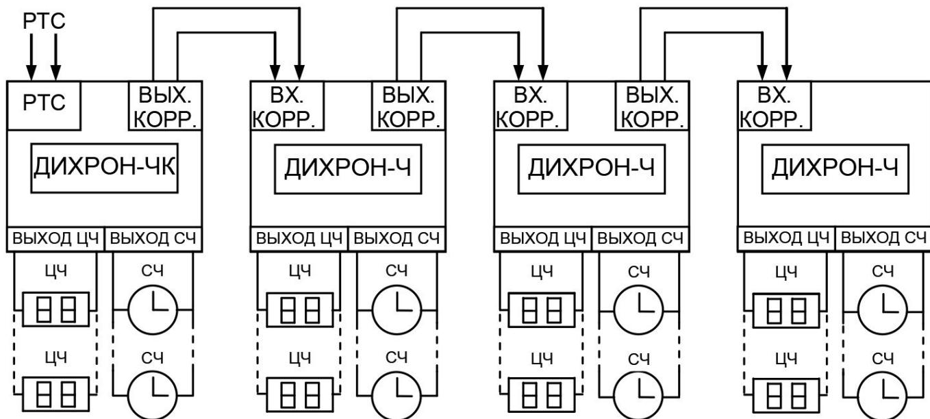
Суммарное сопротивление 2-х проводов между контактами “ВЫХ. КОРР.” предыдущих первичных часов и контактами “ВХ. КОРР.” последующих должно быть не более 150 Ом (до 800 м провода сечением 0,2 мм<sup>2</sup>).
