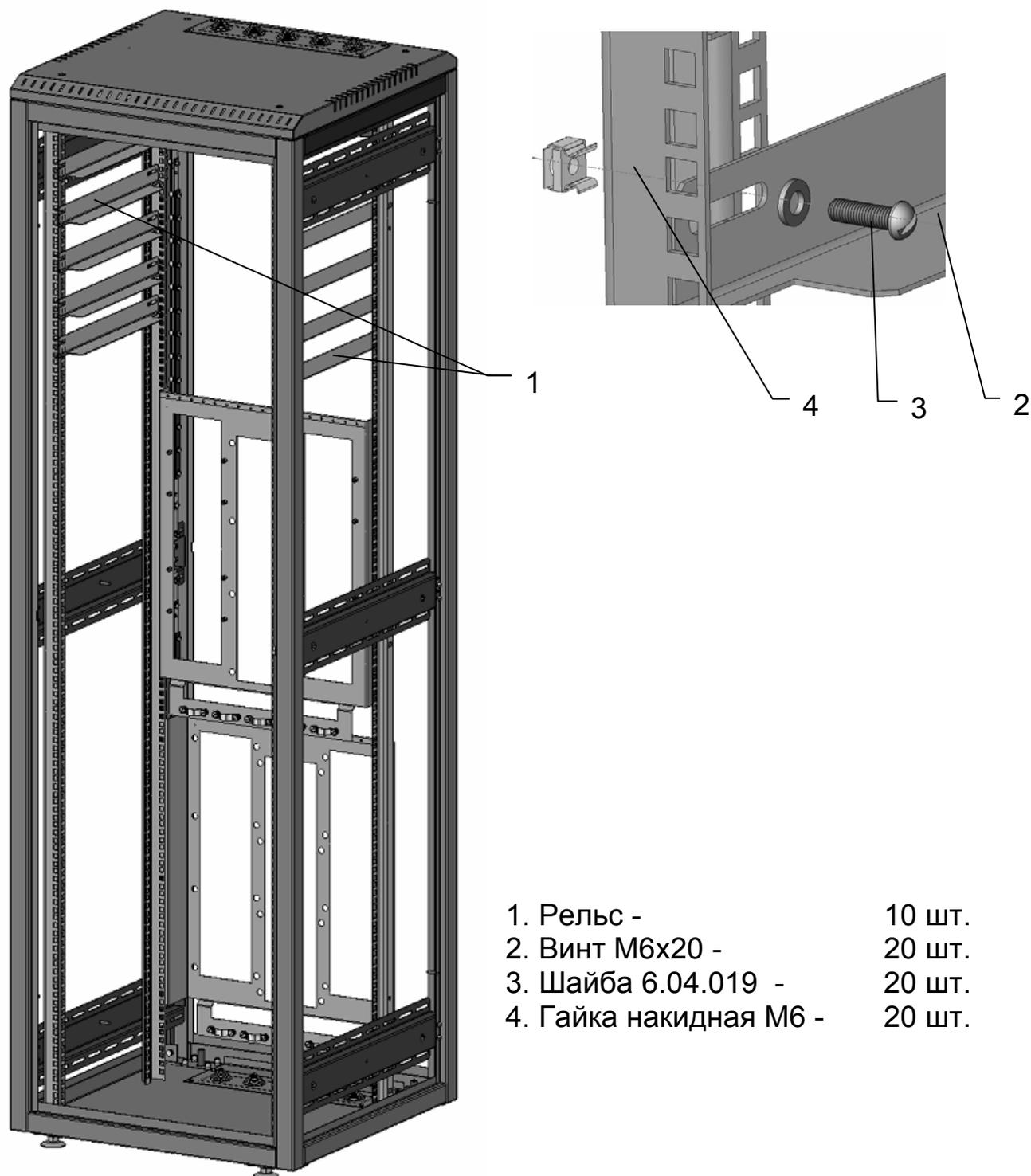
Оставшиеся 10 рельсов устанавливаются попарно на любой высоте для удобного монтажа произвольного оборудования 19" конструктива.
