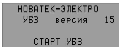
Рисунок 5.10 – Вид индикатора УБЗ-306 после подачи питания
