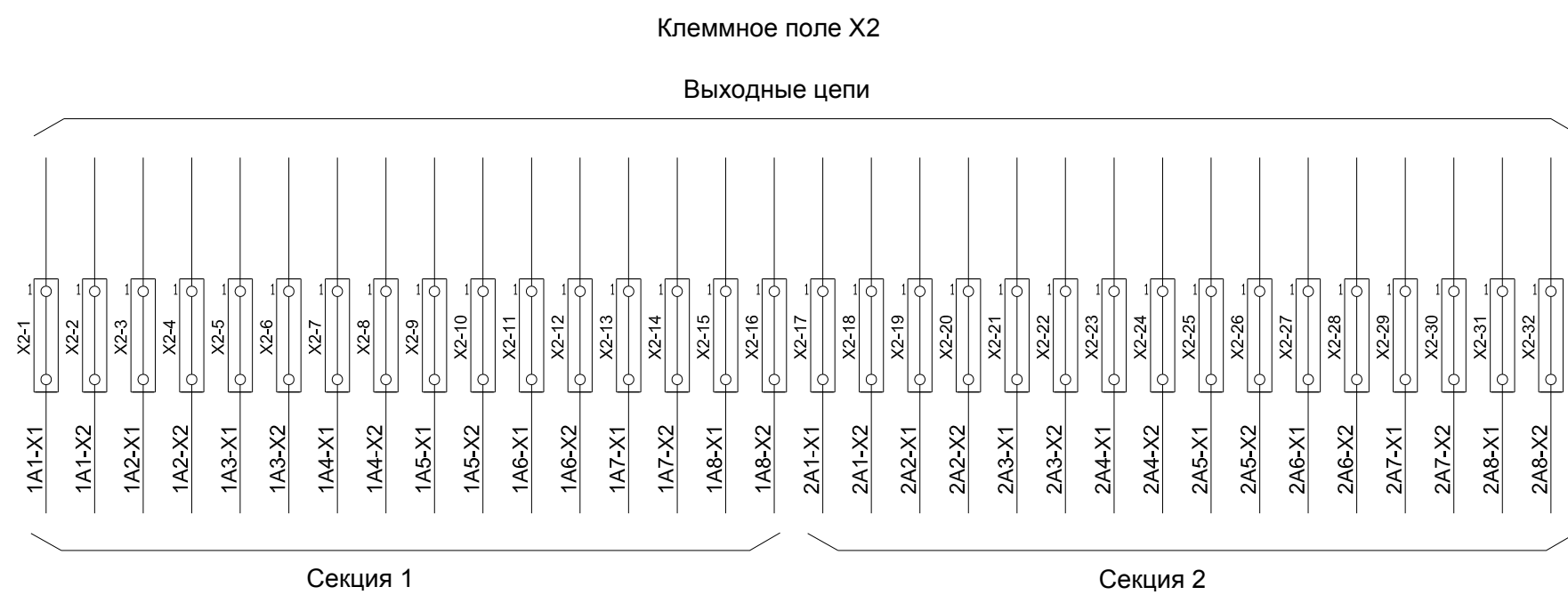
Рисунок М.7 – Лист 2 схемы электрической монтажной ВЗУ-ЭЦС-М2-900-16РЦ ЭТ
