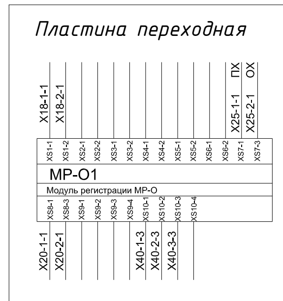
Рисунок М.65 – Лист 2 схемы электрической монтажной ВЗУ-ЭЦС-М1-900-12ЛЦС
