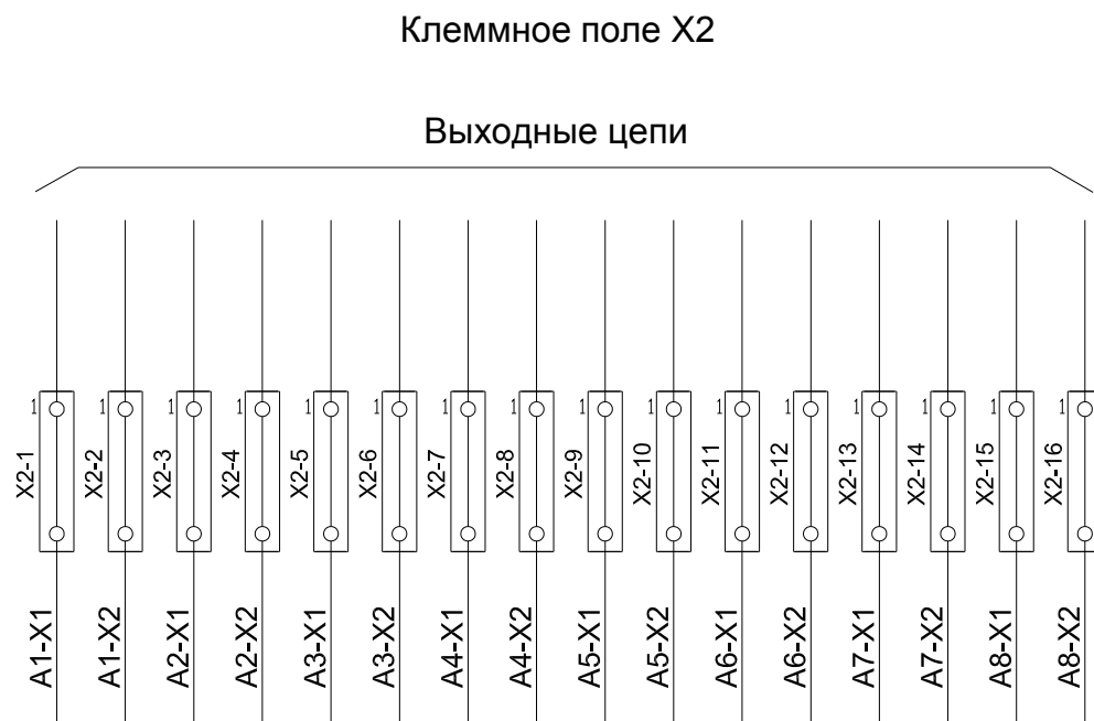
Рисунок М.2 – Лист 2 схемы электрической монтажной ВЗУ-ЭЦС-М1-900-8РЦ ЭТ
