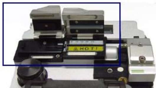
Узел автоматической зачистки волокна
